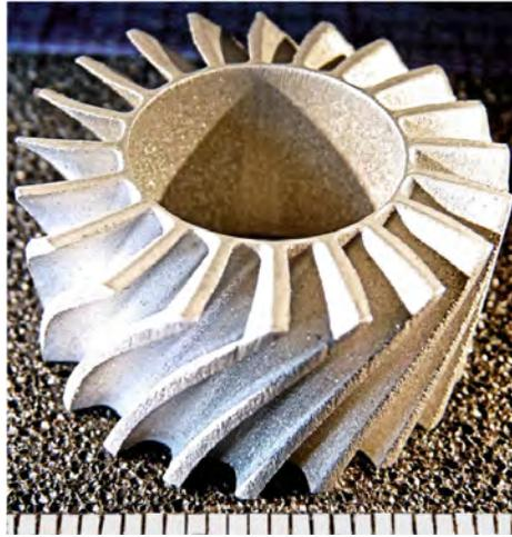
Fig. 21. A-Jet-machined aluminum blisk. Scale: mm.
